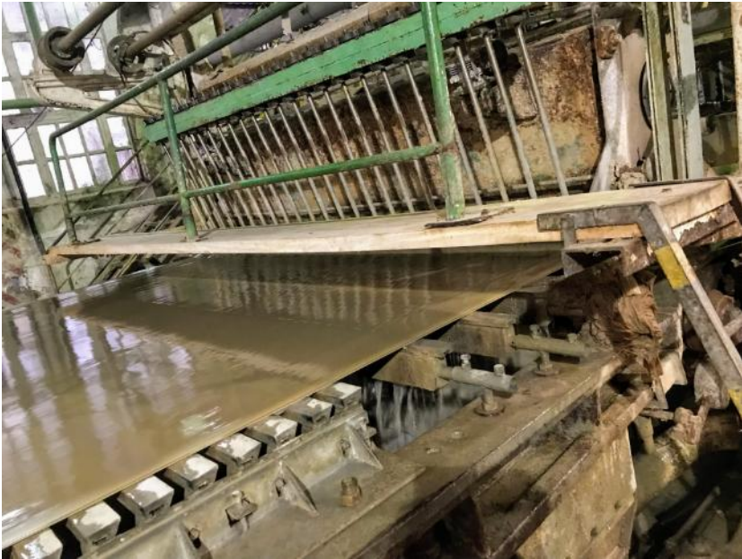
Figura 18. Máquina 1, lugar donde entra la pasta al sector de prensado. Fotografía propia
