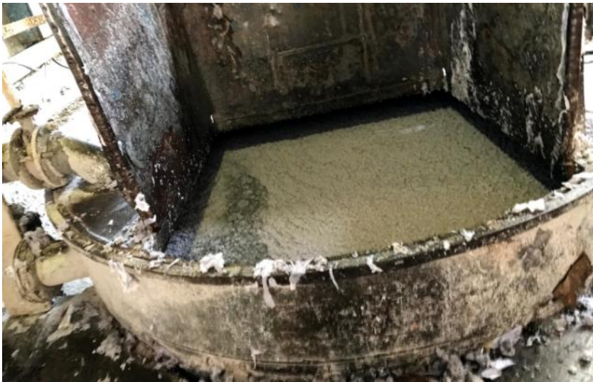
Figura 14. Pulper vacío donde se cargan insumos para papel higiénico. Fotografía propia.
