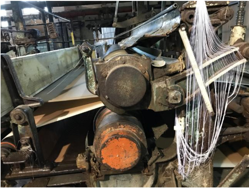
Figura 22. Puesto del 3° ayudante, con piolines que guían la pasta. Fotografía propia
