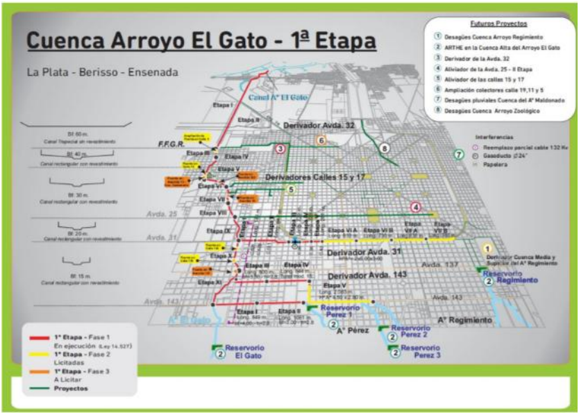
Figura 8. Obras de primera etapa en la cuenca del arroyo del Gato. Fuente: DPOH
