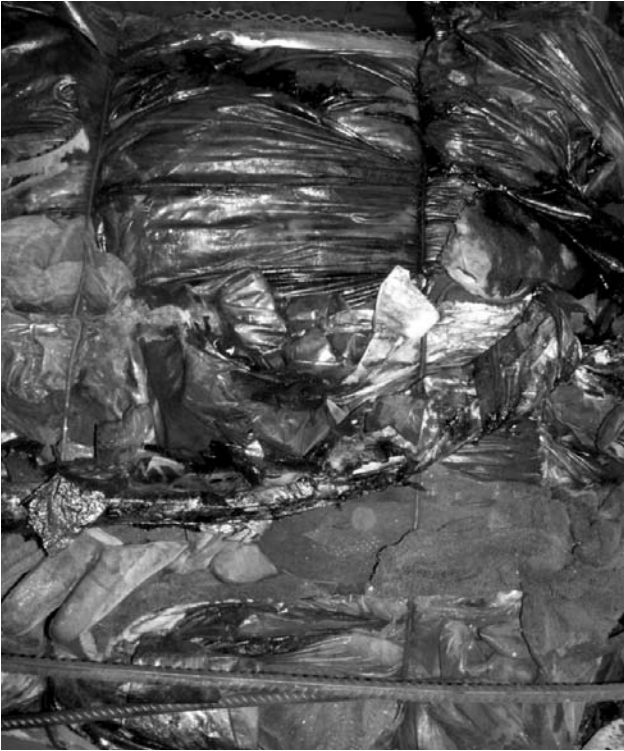
Foto 1. Residuo peligroso, según Ley Nacional 24.051, corriente Y48 contaminada con Y8 e Y9.
